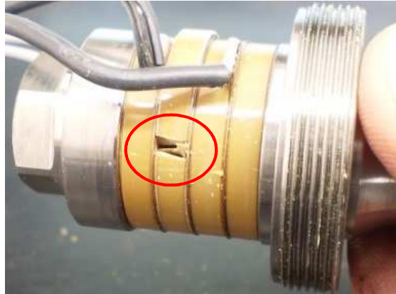
Figura 4 – Conversor ultrassônico com 01 cerâmica piezoelétrica rompida. As demais foram reaproveitadas com segurança após o teste para a detecção de trincas internas.
