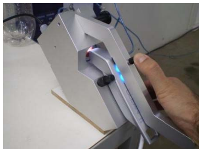
Base de medição com simulador de carga e sensor de vibração (à esquerda) e eletrônica de processamento (à direita).
