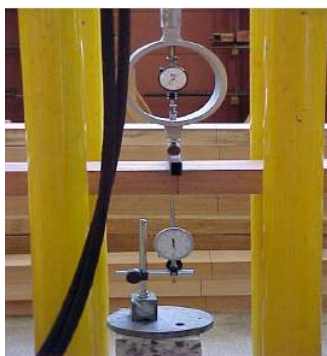
Figura 7 - Ensaio de flexão estática [8].
