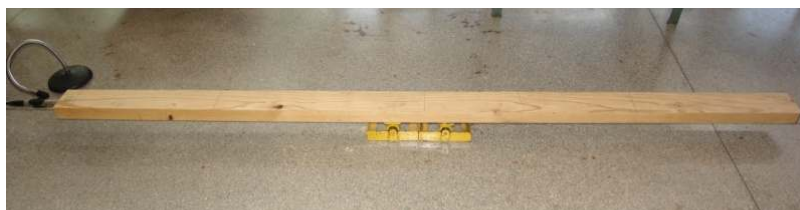
Figura 5 - Posição da viga para o ensaio de reprodutibilidade do Sonelastic®.
