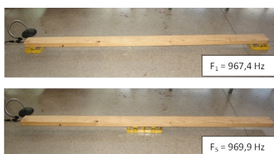
Figura 3. Avaliação da influência do apoio na medição.
