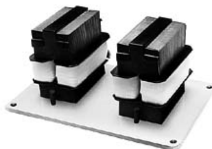
Figura 7 - Foto de um par de transdutores magnetostrictivos. Podemos observar as bobinas enroladas no núcleo de níquel para aplicar o campo magnético (Blue Wave Ultrasonics).
