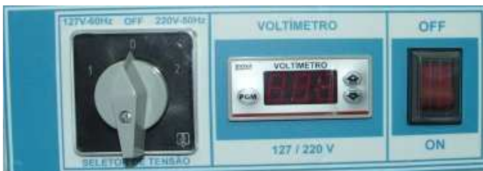
Ilustração 5 Chave seletora na posição neutra e chave geral desligada
