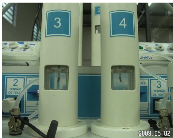
Ilustração 1 Sensores desenvolvidos para captar a emissão acústica da cavitação induzida pelos transdutores.
