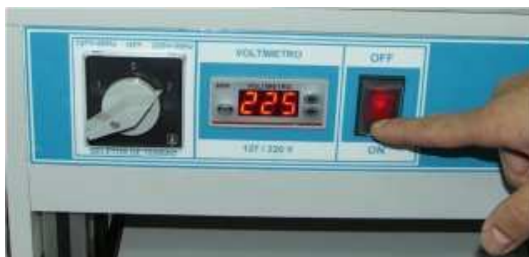
Ilustração 13 Ligação da chave geral para o acionamento simultâneo dos equipamentos.
