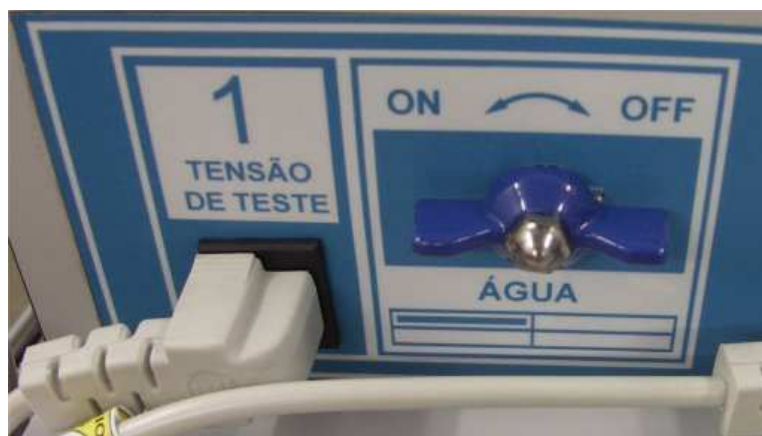
Ilustração 6 Tomada elétrica e válvula de água (na posição fechada) do transdutor 1
